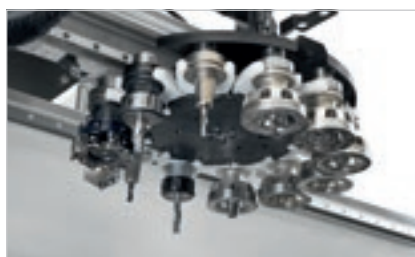
Almacén revólver de 12 posiciones en el cabezal y 12 posiciones a bordo del carro X que minimiza los tiempos de ciclo.
